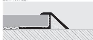
**PROSLIDER CURVE** sono una serie di profili curvabili / sagomabili di raccordo, con una speciale tranciatura deformabile che permette di realizzare e ottenere facilmente in opera forme geometriche particolari, consentendo di creare disegni decorativi a piacimento in funzione alle esigenze tecniche ed estetiche.
